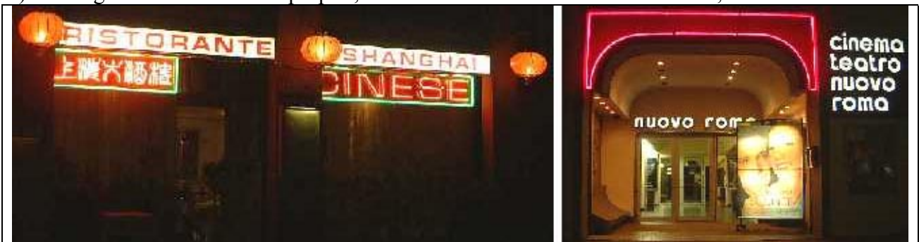
Fig.22 – Alcuni tipi di insegne derogate dalla legge e per le quali la legge richiede solamente, ma solo nelle fasce di rispetto, lo spegnimento dopo le 23 o all'orario di chiusura dell'esercizio. Si vedono: lettere scatolate con illuminazione propria (la scritta cinema), neon nudi (decorazione ingresso al cinema e scritta in cinese), o pannelli ad illuminazione interna (le scritte ristorante e la locandina del cinema).
